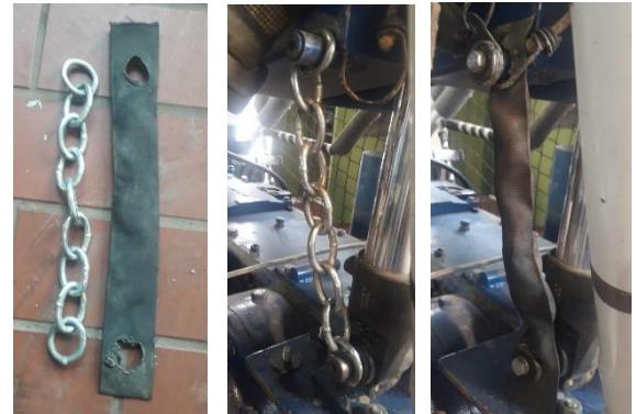
Sitzsicherung alternativ mittels Kette: Die Gliederstärke muss einen Mindestdurchmesser von 6 mm betragen. Die Kette muss an beiden Enden mittels Bolzen (Mindestdurchmesser 10 mm) oder Schrauben (mindestens M10, 8.8) befestigt sein. Schweißen an der Kette ist nicht erlaubt!!! Um Kettenrasseln zu vermeiden kann diese in einen entsprechenden Schlauch eingelegt sein.
